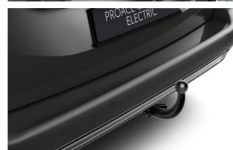
LEVEHETŐ VONÓHOROG Könnyen rögzíthető a vonóhorog bármikor, amikor vontatni szeretne. A rendszer zárható és kitartó korróziógátló felületkezeléssel rendelkezik. Kábelköteg hozzá külön kapható.
