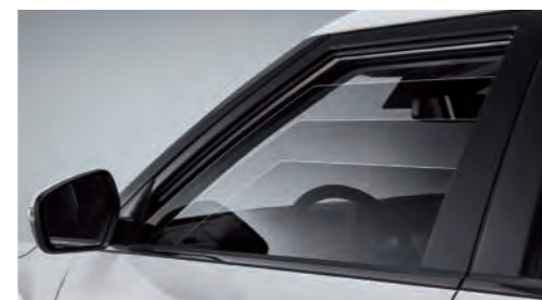
Motoros ablakemelők becsípődésgátló funkcióval, a vezető oldalon
