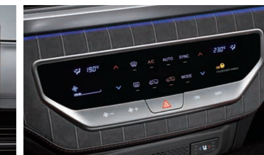
KÉTZÓNÁS, AUTOMATIKUS KLÍMABERENDEZÉS
