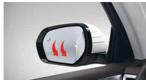
Tolatáskor automatikusan lebillenő külső visszapillantó tükrök
