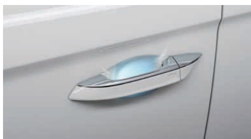
Kétsatornás érintésérzékelő ajtókilincs, világítás a külső kilincsből
