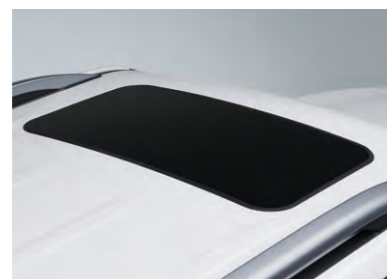
Motoros mozgatású napfénytető becsípődésgátló funkcióval
