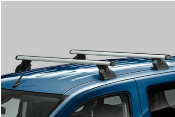
Keresztirányú alumínium tetőrúd 2 darabos készlet, 100kg teherbírás
