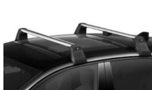
Keresztirányú alumínium tetőrudak
