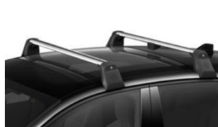
Keresztirányú alumínium tetőrudak
