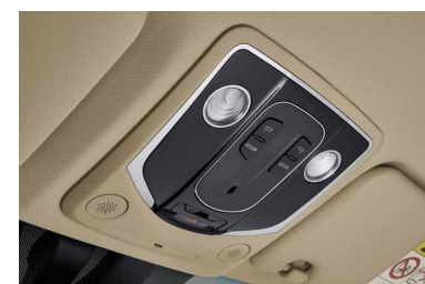
Tetőkonzol térképolvasó lámpákkal (és napfénytető vezérlő kapcsolókkal)
